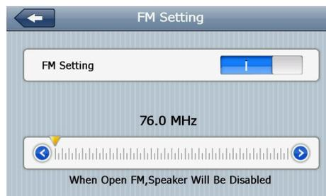
L'émetteur FM sert à transmettre le signal audio à l'appareil récepteur. Prenons l'exemple de FM 90,0 MHz. La fréquence de navigation est désormais la même que la fréquence de réception, soit 90,0 MHz. Les deux appareils sont désormais dans la même bande de fréquences, ce qui permet à la navigation de produire le son.
