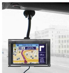
Remarque : Lors de l'utilisation du support, veillez à bien le positionner. Ne fixez pas le navigateur à un endroit où la vue du conducteur pourrait être gênée. Ne le posez pas sur le côté ; ne le fixez pas à l'airbag ni sur sa portée étendue.
